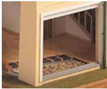
Isolation thermique sous le plancher
